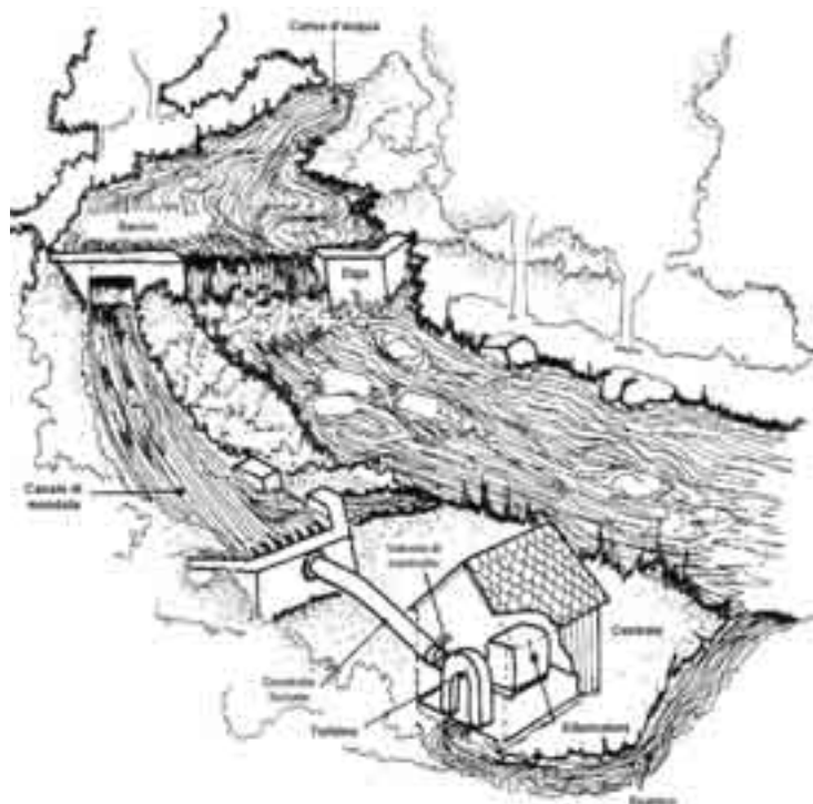
Figura 24. Schema-tipo di installazione idroelettrica
