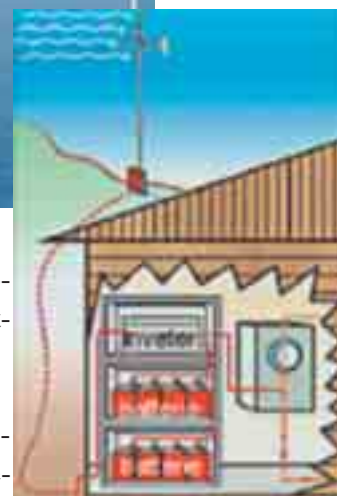
Figura 20. Piccolo impianto eolico
